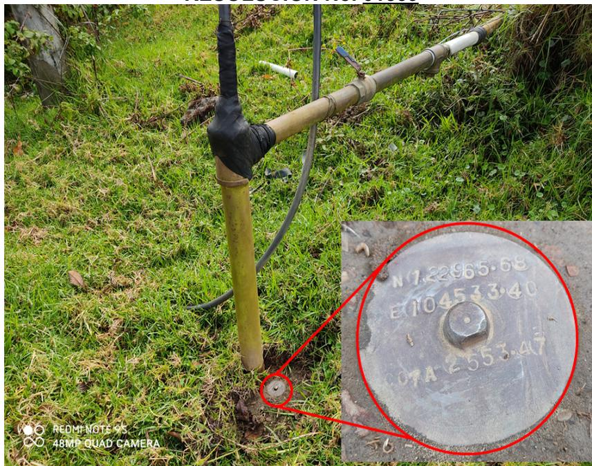
**Foto 6. Placa de georreferenciación y nivelación del pozo pz-01-0026**
